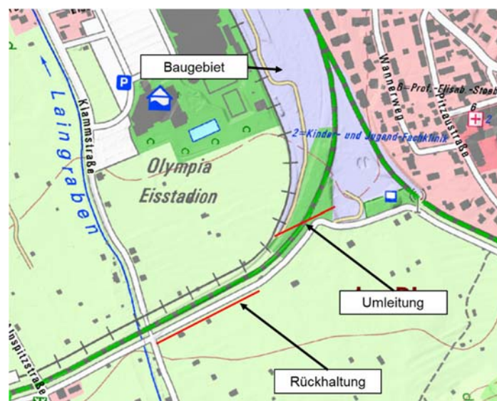
Abbildung 6.2: Mögliche Schutzmaßnahmen durch Rückhaltung oder Umleitung
